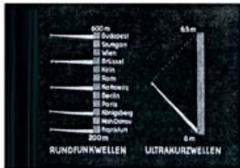
Vergleich des Frequenzbandes von Rundfunksendern mit dem eines Fernseh-senders
