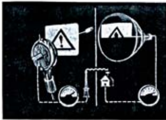
Von der Fotozelle über den Sender zur Braunschen Bildröhre
