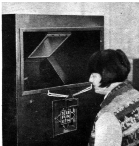
So sitzt die Schauspielerin, die ferngesehen werden soll, vor der Fernseh-Apparatur im Rundfunksender.
