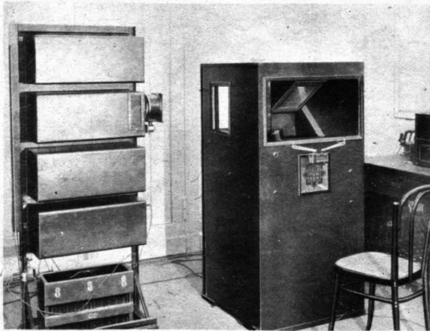
Die komplette Sendeapparatur des Fernsehers, die man bei jedem Rundfunksender zur Aufstellung bringen kann. Links das Verstärkergerüst,
